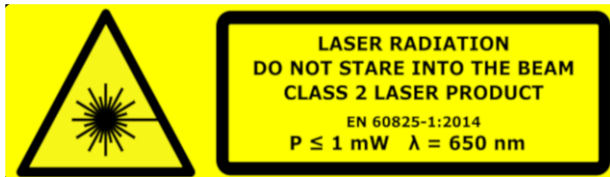
Abbildung 2: Gerätekennzeichnung Laserstrahlung Klasse 2
